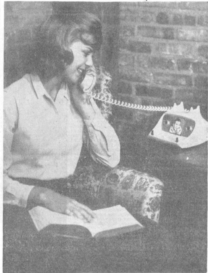
Il «videofono», il telefono del futuro che permette agli utenti di vedersi mentre conversano, è stato già sperimentato con successo negli Stati Uniti e altrove. Prima che possa essere immesso sul mercato occorre risolvere però i problemi connessi con l'alto costo delle linee necessarie per trasmettere l'immagine.
